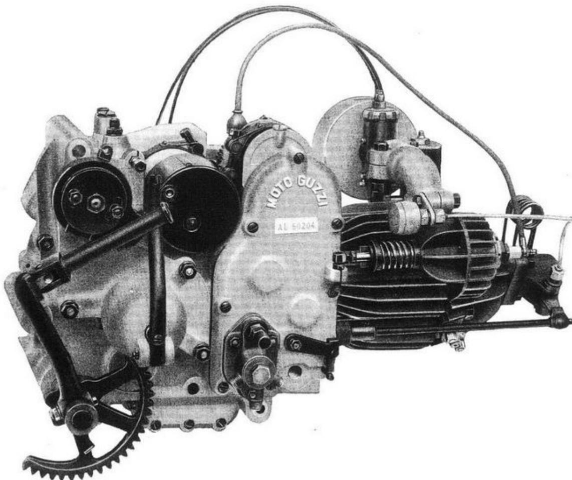
Fig. 27 - Gruppo motore-cambio montato
