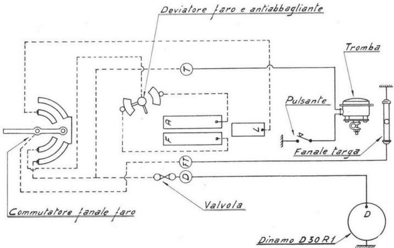
Fig. 26 - Schema delle connessioni dell'impianto elettrico
