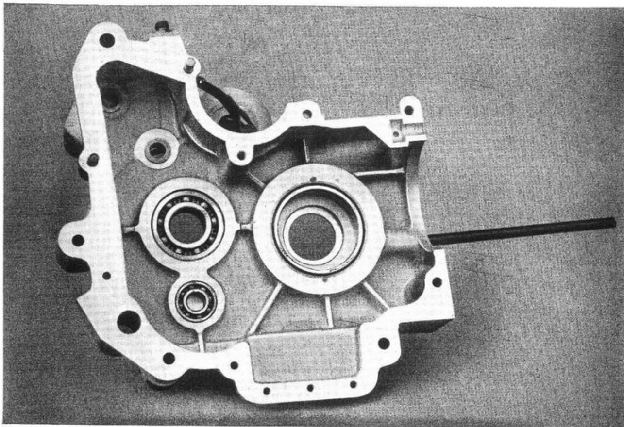
Fig. 18 - Mezzo carter sinistro - Si notino i cuscinetti degli alberi del cambio e l'alloggiamento del cuscinetto a rulli per asse motore
