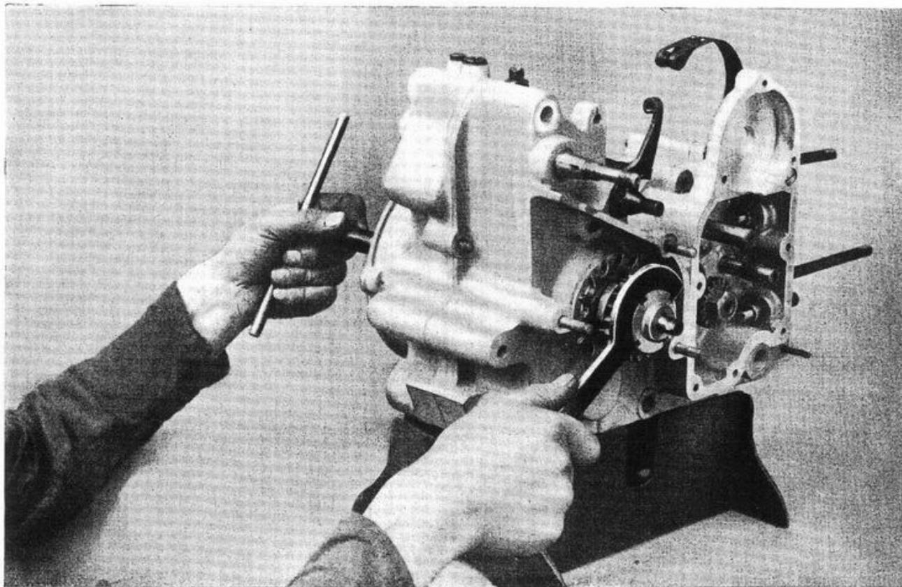
Fig. 12. - Come si leva il manicotto dentato per la messa in moto
