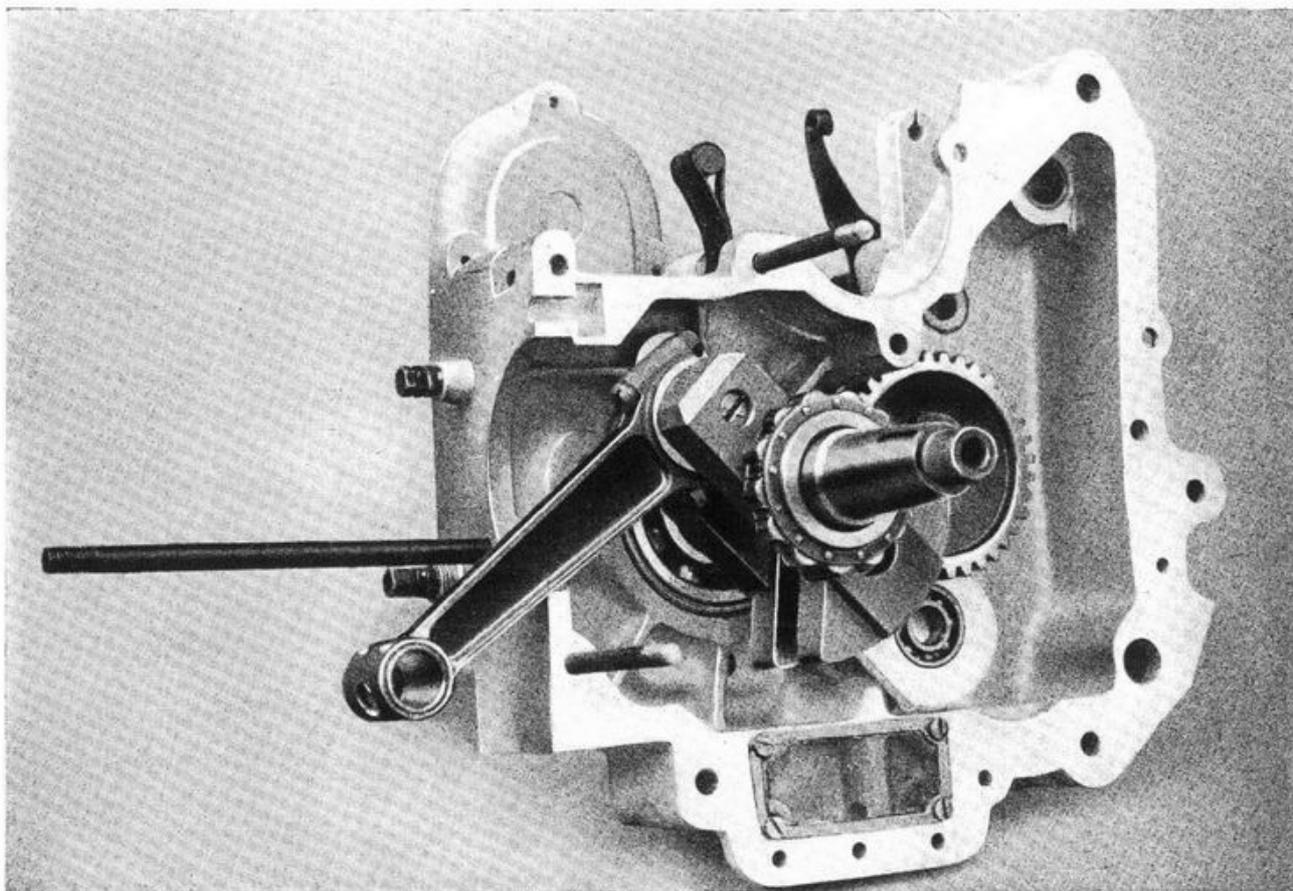
Fig. 16 - Ecco il mezzo carter destro così come si trova appena operata la separazione. Si notino montati l'albero a gomito completo e l'ingranaggio per presa diretta del cambio.
